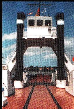
Das Einendeisenbahnfährschiff Stralsund mit 2 zweistufigen Expansions Kolben Dampfmaschinen ist das einzige seiner Art in Europa. Es ist 37,46 m lang, 9,80 m breit und erreicht eine Geschwindigkeit von 8 Knoten.
