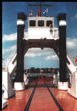
Das Einendeisenbahnfährschiff Stralsund mit 2 zweistufigen Expansions Kolben Dampfmaschinen ist das einzige seiner Art in Europa. Es ist 37,46 m lang, 9,80 m breit und erreicht eine Geschwindigkeit von 8 Knoten.
